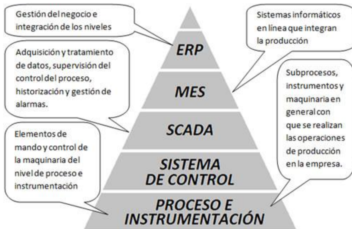
Figura 1: Pirámide de Automatización. 1
