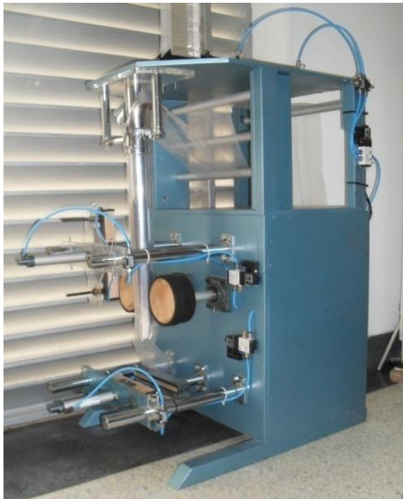
Figura 3: Empacadora en su fase 1 3
