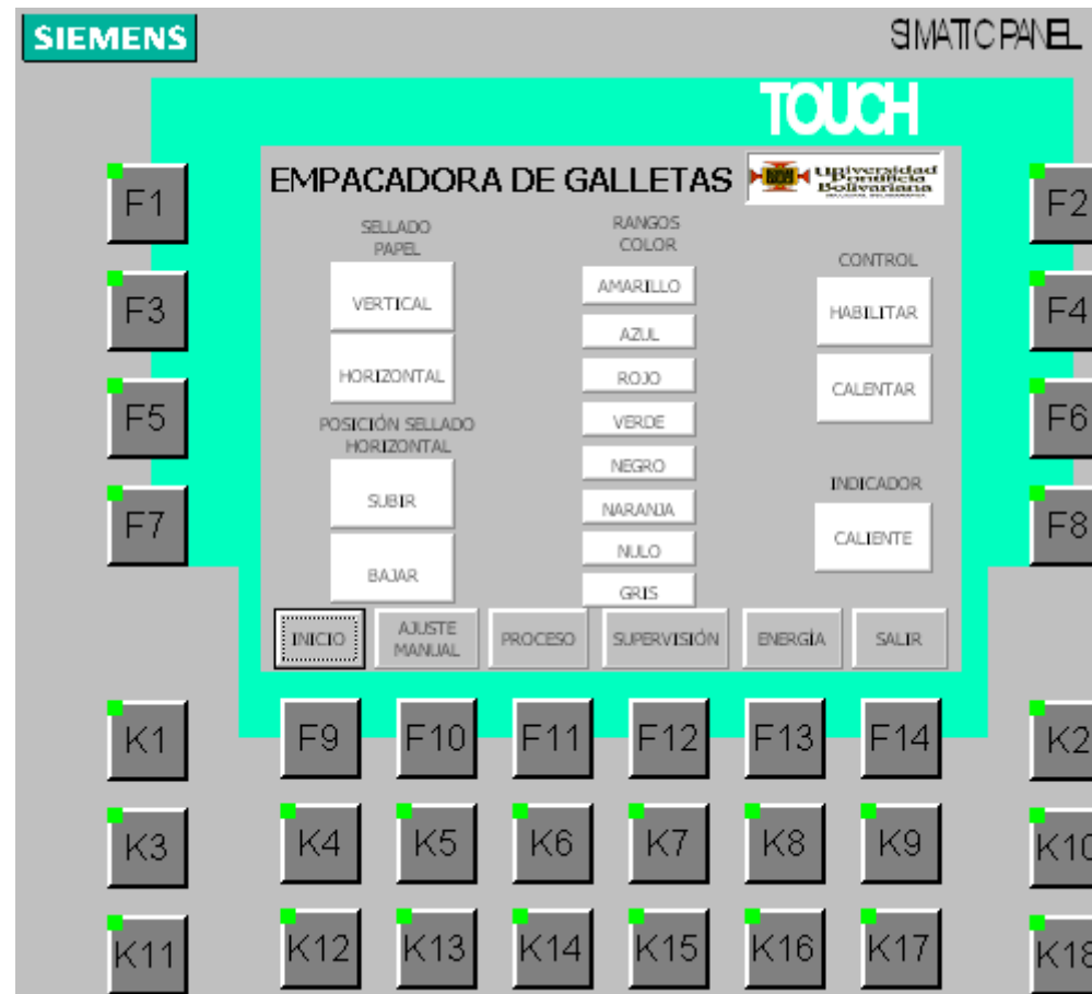
Figura 55: Ventana de ajuste de papel y rangos de color de la HMI 62
