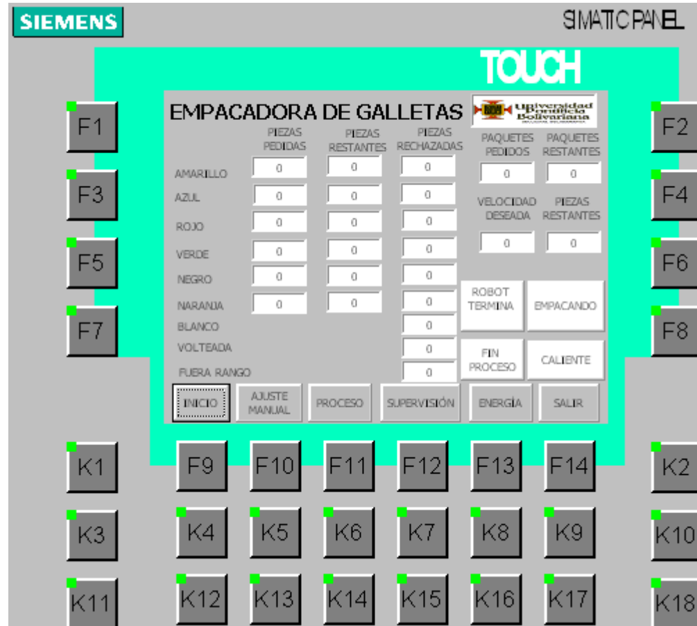
Figura 57: Ventana de supervisión de la HMI 65
